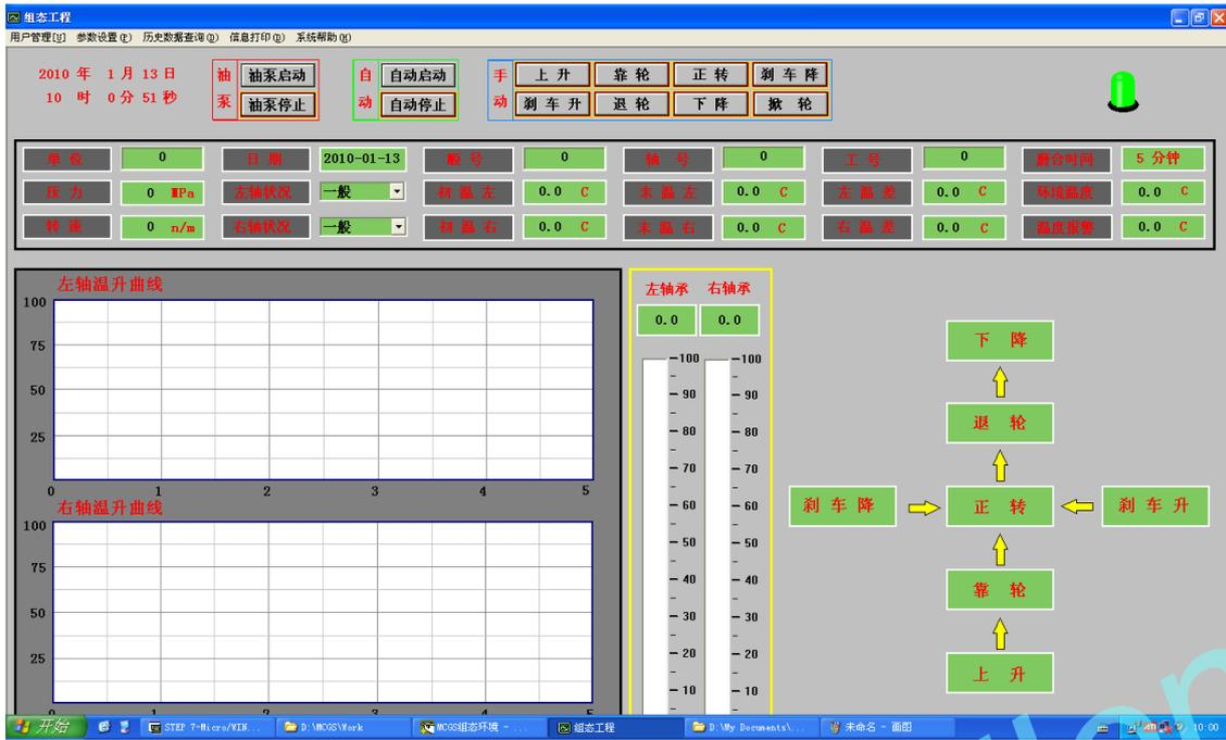
8.7、将控制参数中上升、靠轮、旋转等项目按照实际经验值进行时间设定，并将对应的保护控制参数（即超出控制参数的允许时间）进行相应设定。若设备在某工段控制参数结束后不停机，计算机可在该工段保护控制参数时间完毕后停止该工段；
